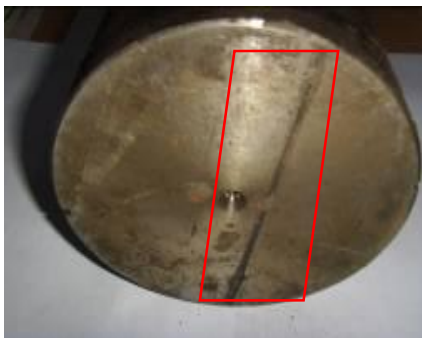
图 9 动铁芯柱塞端部磨损示意图
