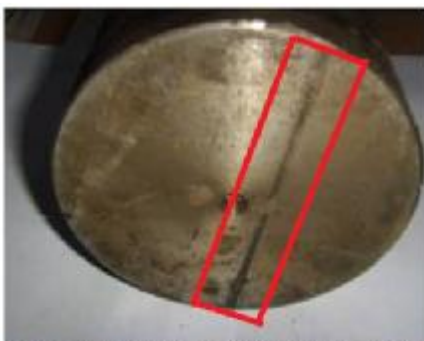
图10 动铁芯柱塞端部磨损示意图
