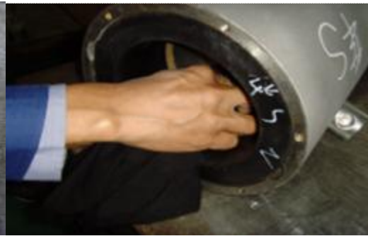
图 6 清理制动器内部
